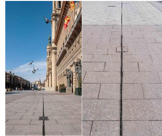
Рис. 2.10 — Прихована дренажна система на площі Пласа-дель-Пілар у Сарагосі, Іспанія, (ULMA Architectural Solutions, 2025)
