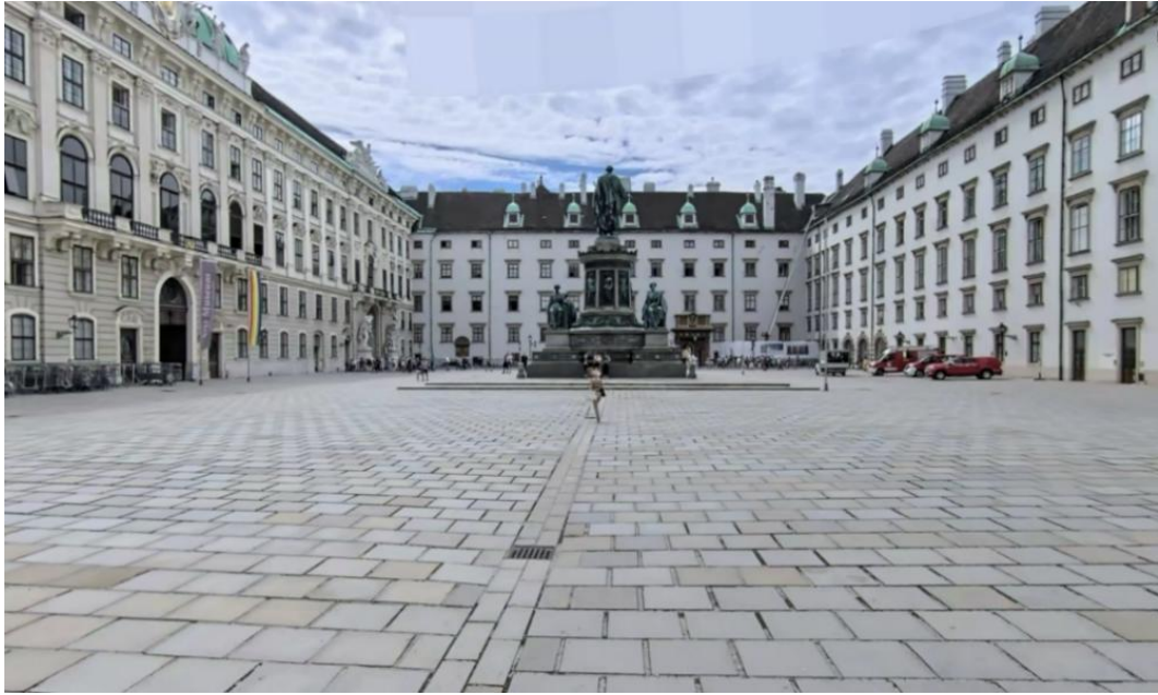
Рис. 2.49 — Площа всередині імперського палацу Хофбурґ у Відні, Австрія. Використання прихованого водовідведення а також тротуарного покриття для забезпечення зручного пересування на кріслі колісному (Apple Maps, n.d.)
