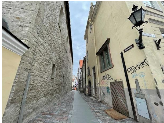
Рис. 2.9 — Локальні вставки гладкої плитки або смуги, які роблять ключові точки (підходи до входів, зупинки, переходи) доступнішими, не змінюючи всю площу. Вулиця в Таллін, Естонія (WheelchairTravel.org, 2023)
