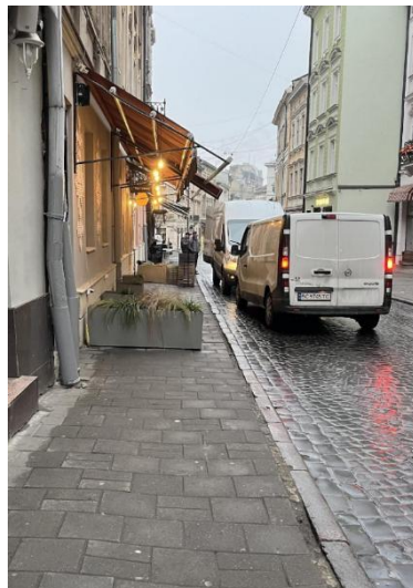
Рис. 2.32 — Клумби, є типовим бар'єром для МГН, зокрема для користувачів крісел колісних та людей з порушенням зору (Розробка авторів)
