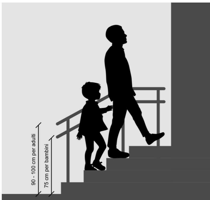
Figura 34. Schema in sezione che illustra le altezze consigliate per i corrimano. (Opera degli autori)
