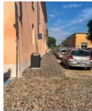
Figura 48-49. Città di Mantova. La prima immagine mostra il percorso di collegamento tra il centro storico e la zona lagunare della città, dove la transizione avviene attraverso una rampa irregolare, di materiali inadeguati e con pendenza eccessiva. Nell'immagine a destra è mostrata una rampa di collegamento tra la strada e il marciapiede, con una pendenza superiore al 10%, che la rende inadatta ad un uso sicuro e accessibile (Sebastiano Marconcini, 2025).
