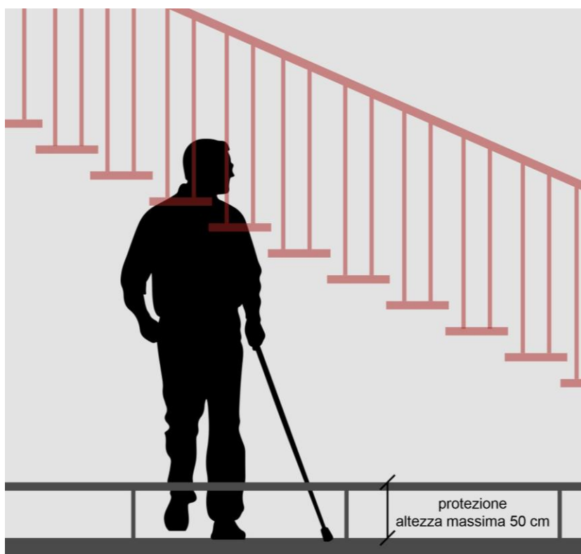
Figura 37. Schema in sezione che illustra una proposta alternativa di una protezione, altezza massima 50 cm, rilevabile dalla persona non vedente attraverso il bastone bianco (Opera degli autori)
